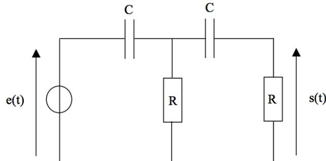
1. Etudier le comportement de ce filtre en basses fréquences puis en hautes fréquences et en déduire le type de filtre. (1 pt)
