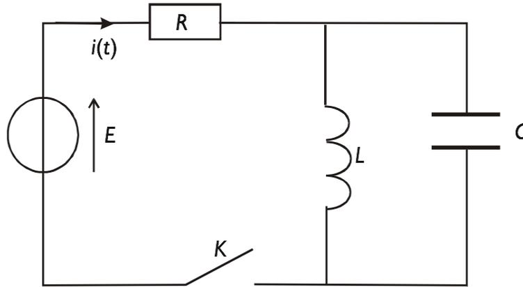
Initialement le condensateur est déchargé et l'interrupteur  $K$  est ouvert depuis longtemps. A l'instant  $t = 0$  on ferme l'interrupteur  $K$ . Dans cet exercice on supposera que
