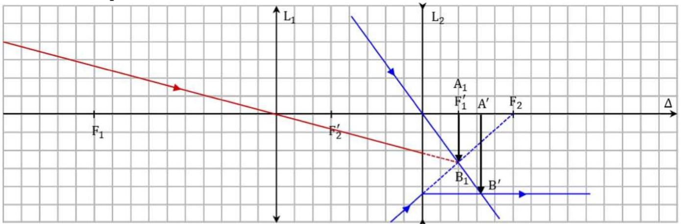
6. On a  $\gamma = \frac{\overline{A'B'}}{\overline{A_1B_1}} = \frac{\overline{O_2A'}}{\overline{O_2A_1}} = \frac{\overline{O_2A'}}{f'_1 - e}$ . La relation de Descartes donne  $\frac{-1}{\overline{O_2A_1}} + \frac{1}{\overline{O_2A'}} = \frac{1}{f'_2}$ . Donc  $\overline{O_2A'} = \frac{f'_2(f'_1 - e)}{f'_1 + f'_2 - e}$  soit  $\gamma = \frac{f'_2}{f'_1 + f'_2 - e} = \frac{5}{3}$  **2 + 1 pts**
