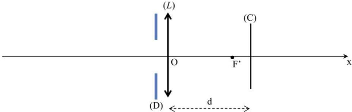
La distance  $d$  entre la lentille ( $L$ ) et le capteur ( $C$ ) est réglable, elle est comprise entre  $d_{\min} = 50$  mm et  $d_{\max} = 55$  mm.
