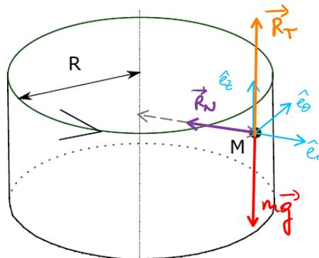
Le but est de maintenir le point  $M$  fixe sur la paroi du cylindre de rayon  $R$ . Le champ de pesanteur est encore parall le   l'axe ( $Oz$ ).
